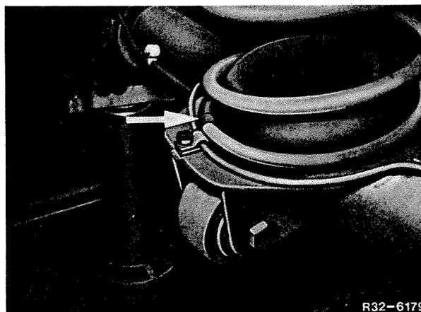
2 Soulever le pont arrière et serrer les deux amortisseurs à 120 Nm sur le pont.
