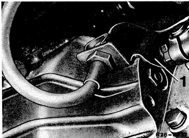
5 Dévisser le cylindre récepteur de la commande d'embrayage du carter de BV, l'extraire, les flexibles et conduites étant raccordés, et le placer de côté. Ce faisant, faire attention à la rondelle intermédiaire de plastique sur la bride du cylindre récepteur.
