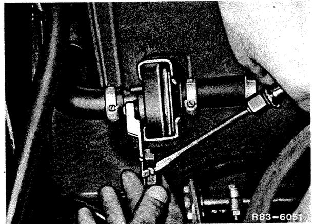
**13** Déconnecter les flexibles d'eau de refroidissement au niveau du robinet d'arrêt et de la conduite.
