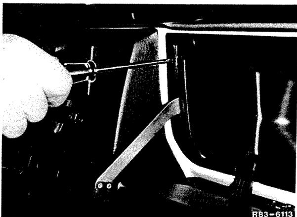
12 Visser le bouchon de vidange du radiateur. Faire le plein d'eau de refroidissement. Contrôler l'étanchéité du circuit de refroidissement.
