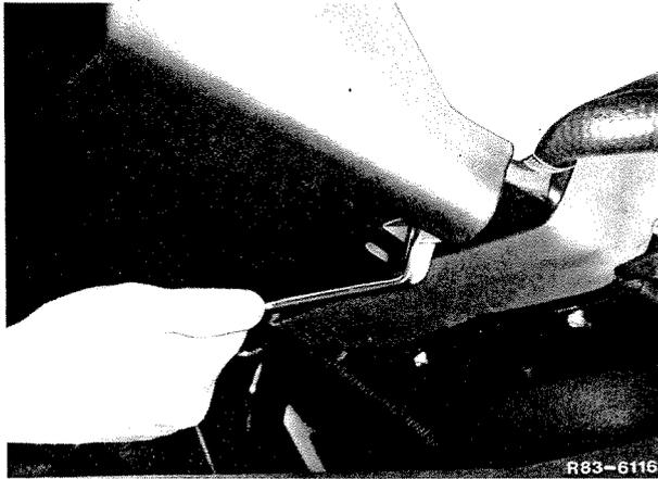
7 Déposer le cache des leviers de réglage.
