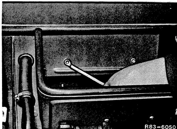
15 Dévisser la fixation inférieure extérieure de la batterie de chauffage.
