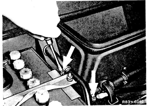
5 Poser les canalisations d'air et les buses de dégivreurs et les fixer.
