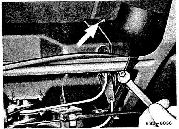
**11** Déposer les canalisations d'air.
